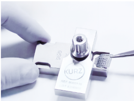
Abb. 3: Dicke des Knorpelpräparats = 0,7 mm abzüglich der Dicke der Distanzscheiben
